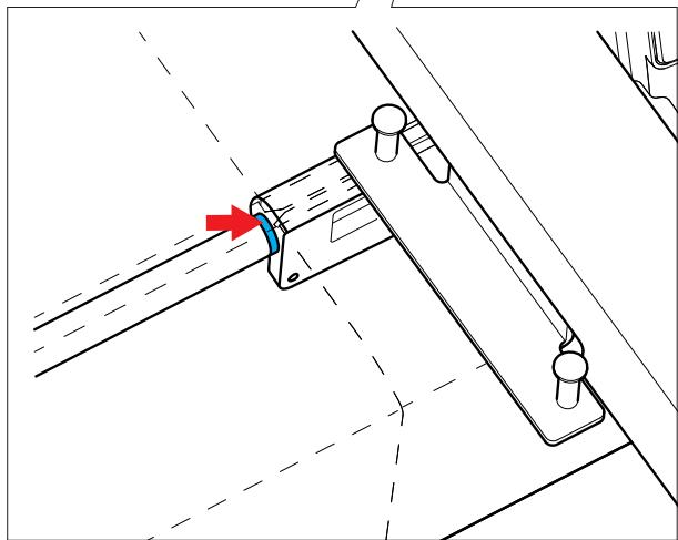
Namažte bod označený šípkou (plstěná podložka) uvnitř ramene, viz obrázek.
