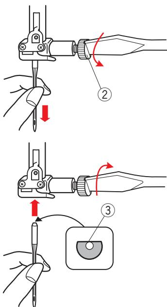
Zdvihněte jehlu otáčením ručního kola. Vypněte hlavní vypínač stroje nebo stiskněte zamýkací tlačítko.
